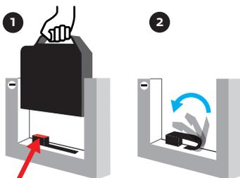
Wenn Sie den Akku entfernen, wird der Kontaktstecker freigelegt.
