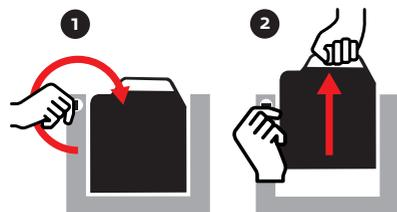
Stecken Sie den Schlüssel ein und drehen Sie ihn im Uhrzeigersinn.
